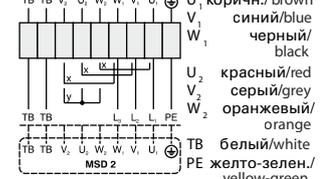
x перемычка для высоких оборотов / bridge for high speed
