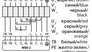
x перемычка для высоких оборотов / bridge for high speed
